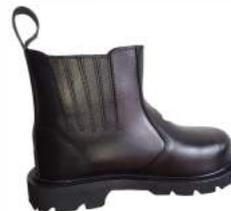
Fabricado en cuero Box Calf, con planta de nitrilo, puntera de acero, interior de badana, pegado y vulcanizado.
