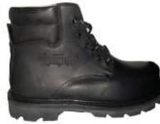
Fabricado en cuero graso acuático, planta de nitrilo, punta de acero con cerco de PVC interior de badana, pegado, cosido y vulcanizado.
