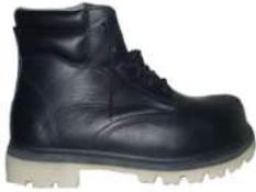
Fabricado en cuero Box Calf, planta de caucho, puntera acrílica, con cerco de PVC, interior de badana, pegado, cosido y vulcanizado.
